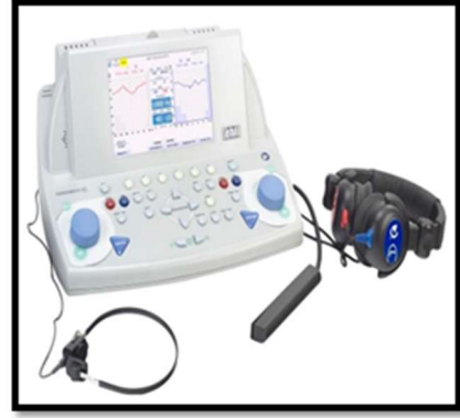
صورة عدد ١: آلة عمل اختبار "مقياس سمع الكلام"
